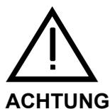
**Im Lokalbetrieb ist die Wiedereinschaltsperrung inaktiv ! Ein häufiges und kurzes Einschalten kann zu Beschädigungen am Kompressor führen !**
