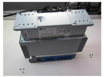
Die vorhandenen Montageplatten abschrauben, dabei die Schrauben für die nachfolgende Verwendung bereithalten.
