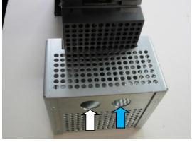
Führen Sie das Netzkabel (weißer Pfeil) und das Motorkabel (blauer Pfeil) durch die Unterseite der vorderen Gehäuseabdeckung und schließen Sie diese ordnungsgemäß an. Nun wird die Klemmenabdeckung wieder eingesetzt und der zweite Teil des Gehäuses unten angeschraubt.
