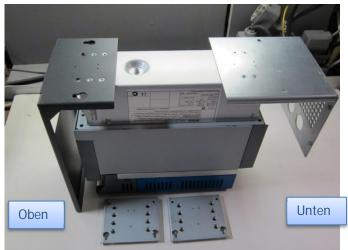
Obere schwarze Gehäuseabdeckung IP40 und Rückteil des unteren Gehäuses wie abgebildet mit den vorhandenen Schrauben befestigen.
