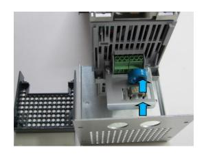
Das Schirmkontaktierungsblech mit den am Umrichter vorhandenen Schrauben befestigen.
