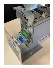
Die Steuerkabelführung mit den mitgelieferten Schrauben am FU befestigen.
