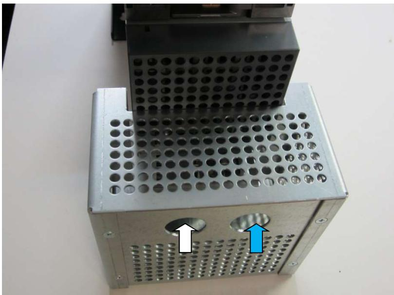
Passez câble d'alimentation (flèche blanc) et câble du moteur (flèche bleue) à travers du couvercle inférieur et installez part 2 du couvercle inférieur.
