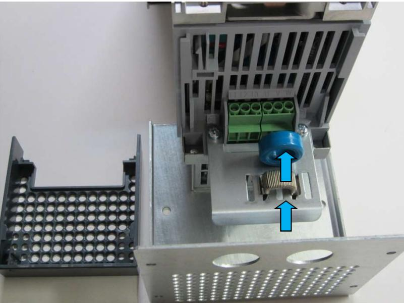
Fixer la plaque de montage pour le câblage électrique utilisant les deux vis à droite et à gauche des bornes de connexion.
