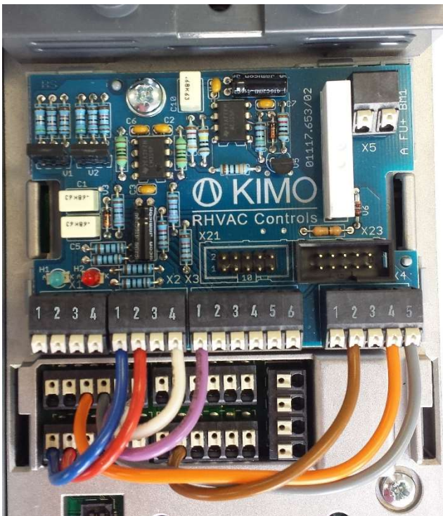
Anschlüsse Klemmenleiste im Umrichter Terminal connections in the Inverter
