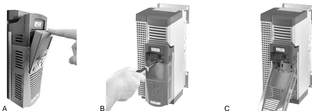
Nach dem Lösen der Schraube (D) lässt sich das Steuermodul durch Abziehen entfernen (E). Setzen Sie nun das neue Steuermodul ein und fixieren Sie die entsprechenden Schrauben in umgekehrter Reihenfolge.
